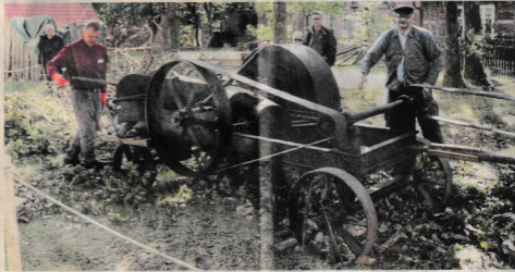
Philipp Ramünke (rechts) und Karl-Heinz Manke (2. von links) führten eine Busch-Hackmaschine aus dem Jahr 1947. Diese wurde über Riemen von einem 75 Jahre alten Trecker angetrieben.
